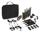
Bis zu 10 km Reichweite IPx4 Wetterschutz, Easy Pairing-Funktion, LED-taschenlampe, VOX-Funktion Verstecktes Display, 16 Kanäle und 121 Unterkanäle, 500 mW Sendeleistung, 20 Ruftöne, Kanalsuchlauf und -überwachung
